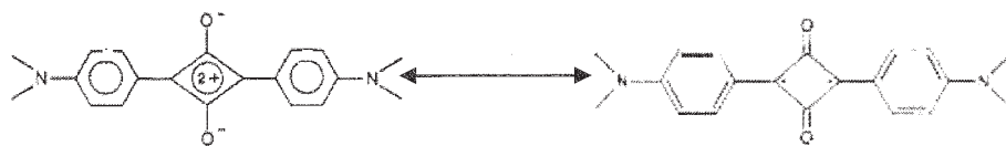
図 5. SQ-DMA分子の構造式 [4],[5]
